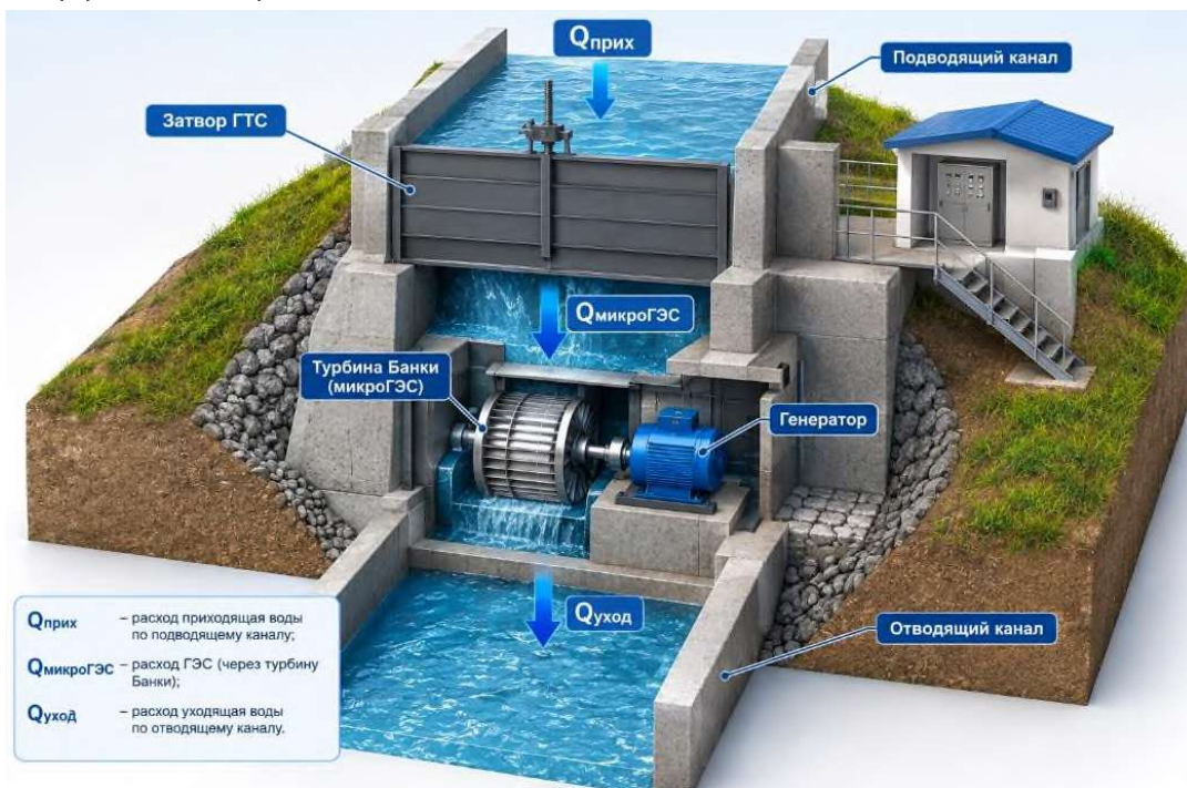
Рисунок 2 - Схема использования затвора гидротехнического сооружения с микроГЭС. (Сгенерировано ИИ). Figure 2 - Diagram of a hydraulic structure gate integrated with a micro-hydroelectric power plant. (Generated by AI).
