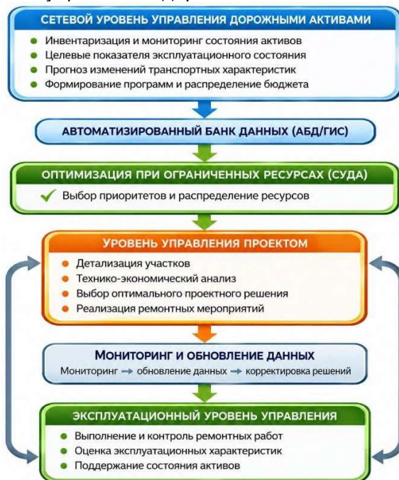
Рисунок 1 – Схема взаимосвязи уровней управления дорожными активами. (Сгенерировано ИИ). Figure 1 – Diagram of the relationship between the levels of road asset management. (Generated by AI).
