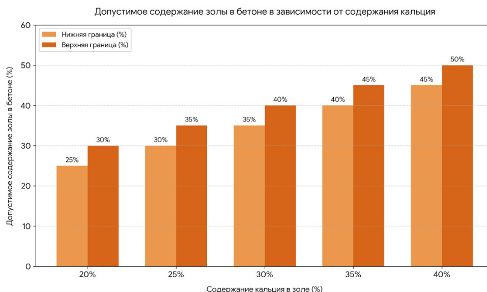
Рисунок 3 – Соотношение между содержанием кальция и допустимым процентом золы в Бетоне
