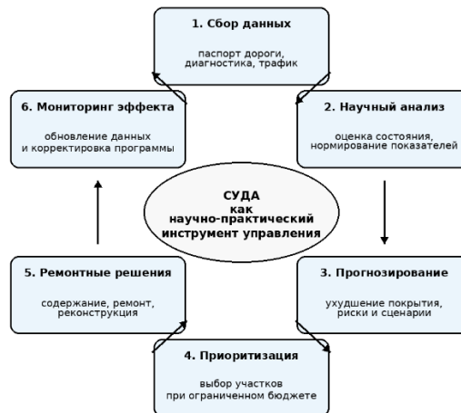
Рисунок 2 - Цикл научно обоснованного управления дорожными активами Figure 2 – Cycle of evidence-based road asset management
