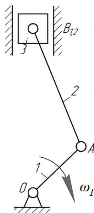
Рисунок 1 – Схема четырёхзвенного КП-4
