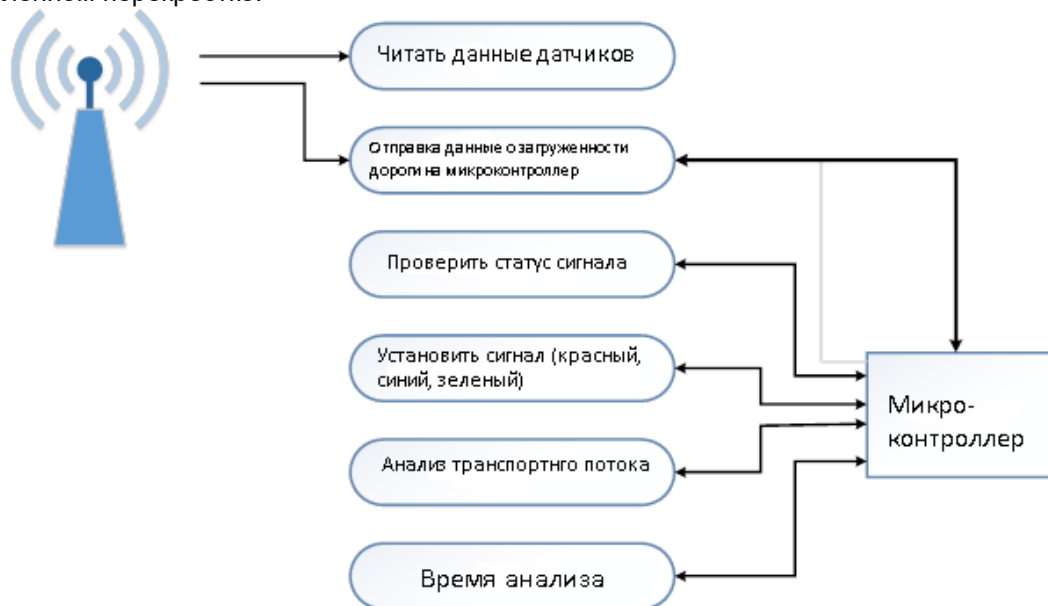
Рисунок 3 – Алгоритм работы системы управления светофором на базе микроконтроллера
