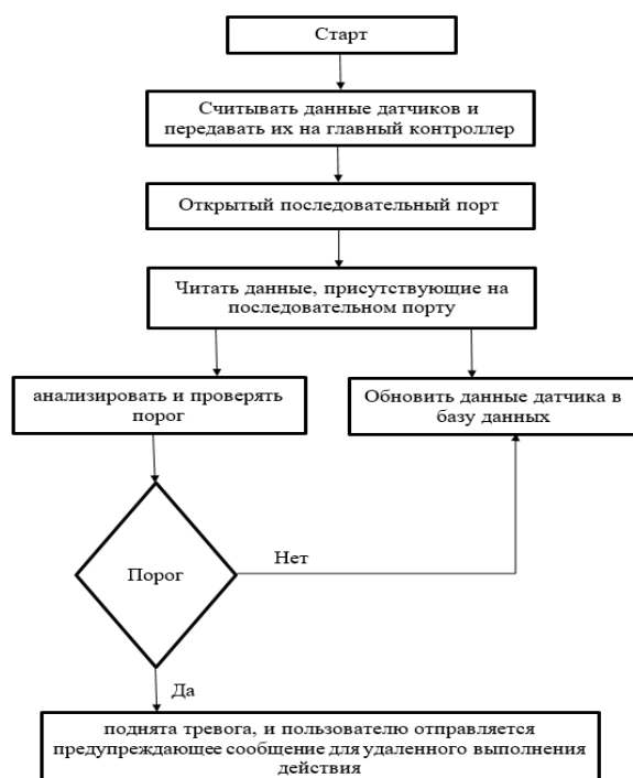
Рисунок 2- Алгоритм работы автоматизированной системы орошения
