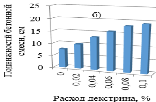
Рис.1. Сравнение показателей пластифицирующего эффекта МЛСТ (а) и декстрина (б) при исследовании бетонных смесей составов (цемент: песок : щебень : вода): а) 1:1,79:3,32:0,5; б) 1:1,03:1,97:0,38.
