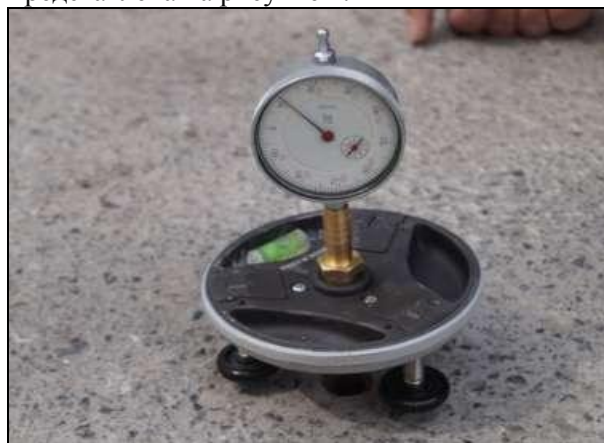
Рис.1. Измерение износа асфальтобетонного покрытия.
