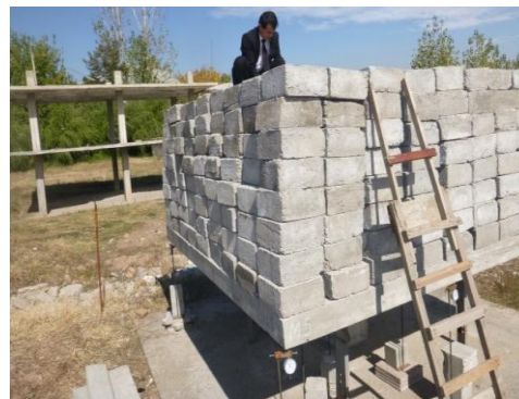
Рис.8. Восьмой этап статических нагружений составила 22,0 \text{ кН/м}^2 .
