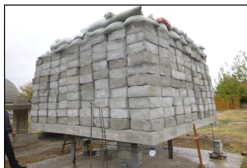
Рис.9, 12 – этап статических нагружений при котором нагрузка составила 31,0 \text{ кН/м}^2 .
