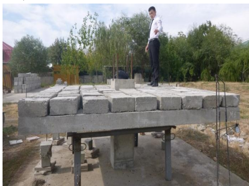
Рис. 7. Начало статических испытаний узла стыка плиты с колонной безригельного каркаса; первый этап нагружения с учетом собственного веса плиты 6,25 \text{ кН/м}^2 .
