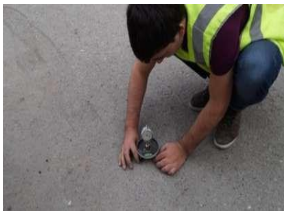
Рис.3. Подготовка прибора к работе для измерения износа дорожного покрытия.
