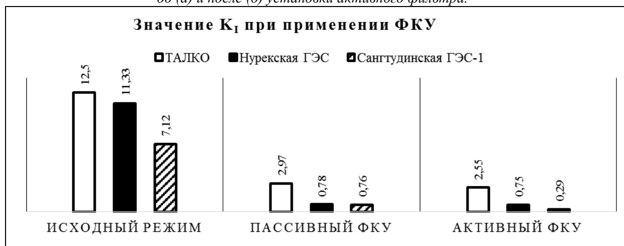
Рис.6. Гистограмма изменения значения суммарного коэффициента гармонических составляющих тока (в %) при применении средств компенсации токов высших гармоник.
