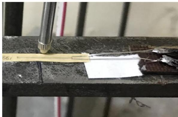
Рис. 4. Тензорезистор типа 2ПКБ (20мм).
