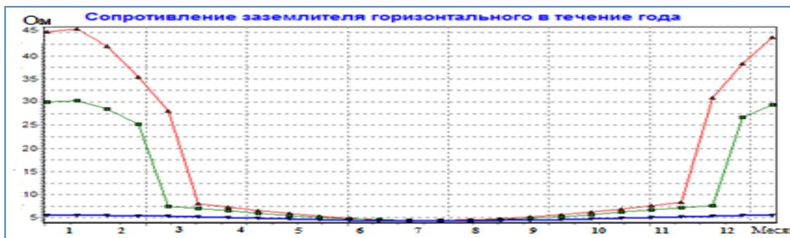
Рис.3. Изменение сопротивления горизонтального заземления в течение года.
