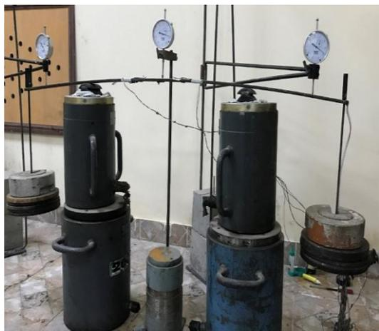
Рис. 1. Испытательный стенд с испытуемой балкой.
