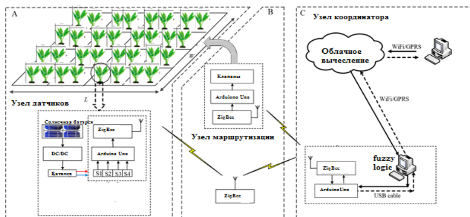
Рис. 5. Схема автоматизированной системы орошения хлопчатника, основанного на дистанционном принципе передачи и приема данных узел датчиков (А) узел маршрутизации (В) и (С) узел координатора.
