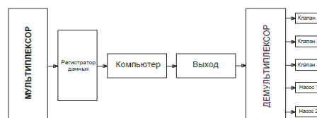
Рис. 4. Схема системы измерения и передачи данных.
