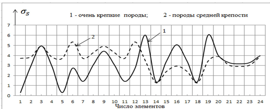
Рис. 3. Распределение тангенциальных напряжений от собственного веса пород
