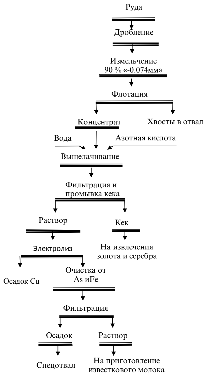
Рисунка 2. Принципиальная технологическая схема переработки золото-, медно-, мышьяковой руды месторождения Тарор.
