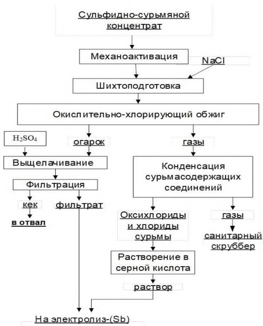
Рисунок 5 - Принципиальная технологическая схема.
