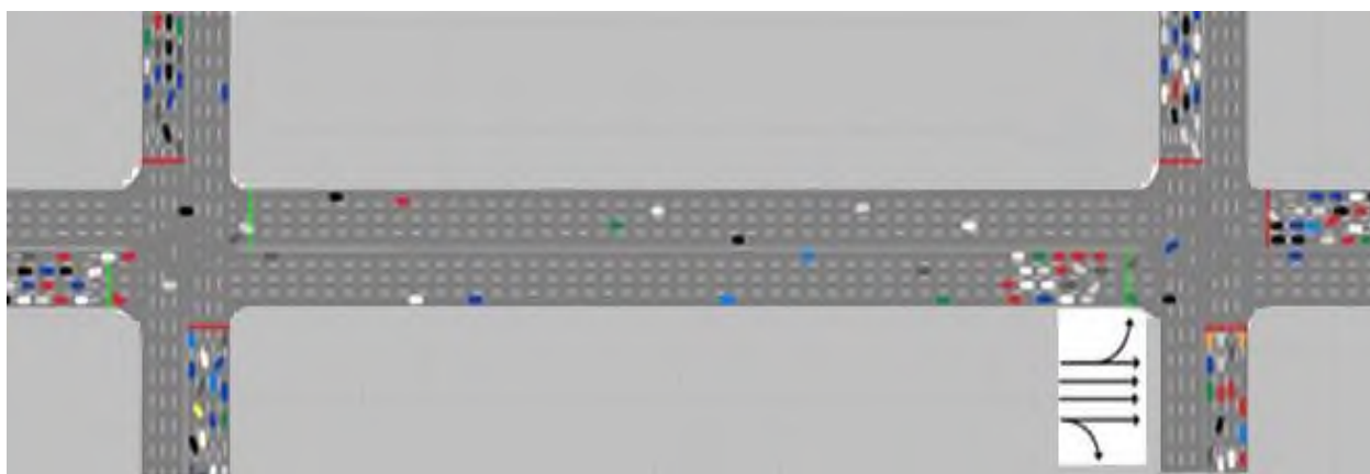
Рисунок 3 – Рассмотренные варианты четырёхполосных сегментов с пересечениями имеющих фаз регулирования, обслуживающих ТП без конфликта левоповоротного движения с прямым потоком (PTV Vissim).
