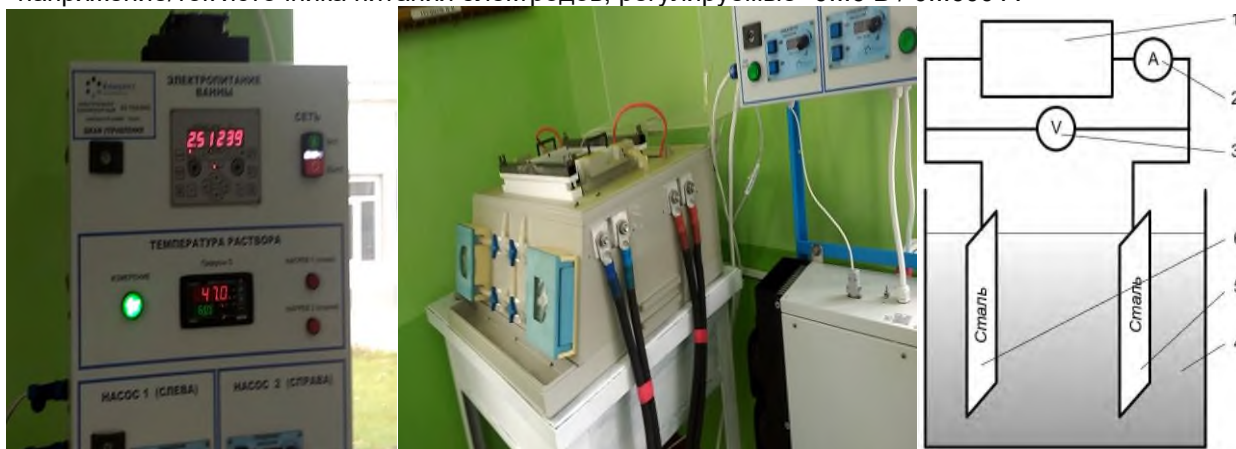
Рисунок 3 – Схема лабораторной установки: 1 – блок питания; 2 – амперметр; 3 – вольтметр; 4 – ячейка с электролитом; 5 – стальной анод; 6 – стальной катод.
