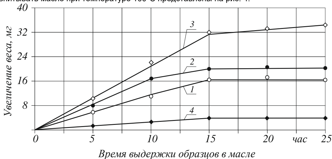
Рисунок 4 – Способность аустенит-марганцовистого чугуна и легированной стали впитывать масло при 100°C: 1 - чугун в состоянии отливки; 2 - закаленный чугун; 3 - чугун после отжига и последующей закалки; 4 - сталь 45Г2 после закалки
