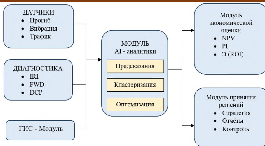
Рисунок 1 - Структура цифровой СУДА с ИИ-модулями
