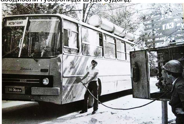
Озмоиши автобуси Икарус бо гази табиӣ (метан) дар шароити иқлими гарм (солҳои 80, асри 20 дар шаҳри Душанбе) [6].
