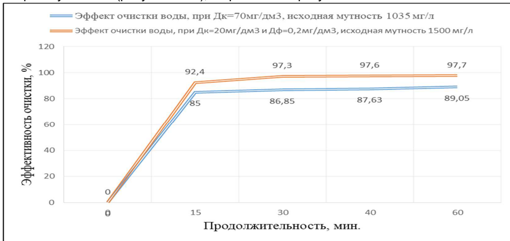
Рисунок 4 - Сравнение эффекта осветления воды при применении традиционного коагулянта и в сочетании с современным флокулянтом
