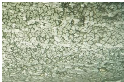
Рис. 5. Макроструктурный анализ сплава систем Al –0.1% Ti– 0.01%Nd.
