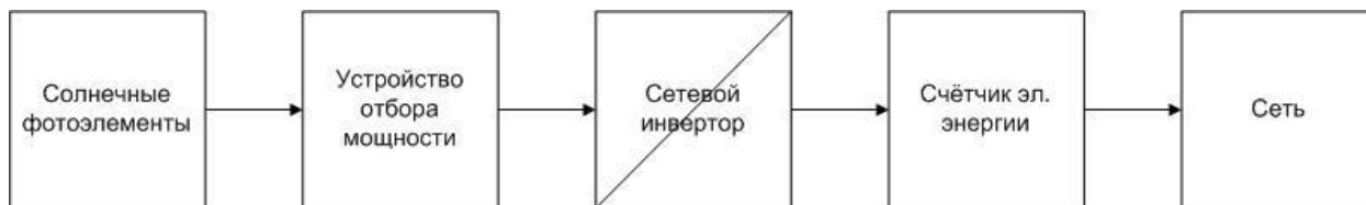
Рис. 5. Функциональная схема ФЭС, синхронизирующейся с сетью.
