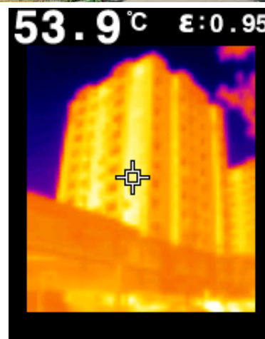
Рис. 2. Качественная и количественная картина термического режима городского каньона меридиональной ориентации
