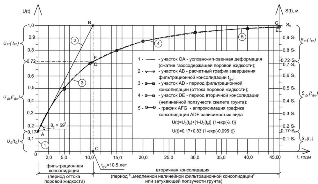
Рис. 1 – Степень уплотнения U(t) и величина деформации S(t) слабо водонасыщенного глинистого грунта на участках: а) OA - условно-мгновенной деформации, б) AD - фильтрационной консолидации, в) DE –вторичной консолидации ( t_{фк} – время завершения фильтрационной консолидации)
