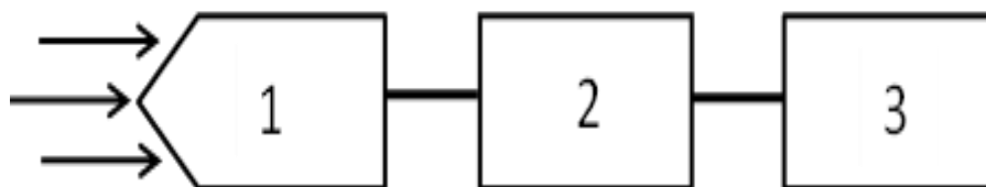
Рис.1 – Блок схема свободнопоточной речной ГЭС: 1- плавящая часть, 2- инвертор, 3- нагрузка
