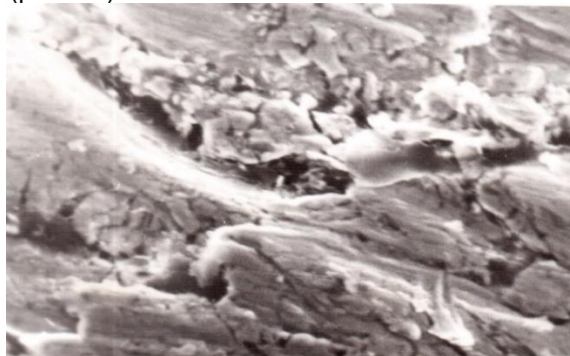
Рисунок 9 – Транкристаллитный механизм скола
