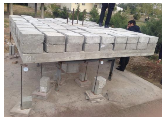
Рис.2. Поэтапное статическое нагружение фундамента.
