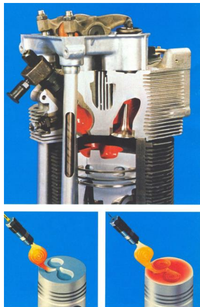
Рис. 3. Камера сгорания дизеля FL413FW и схема двухстадийного процесса сгорания в комбинированной камере сгорания.
