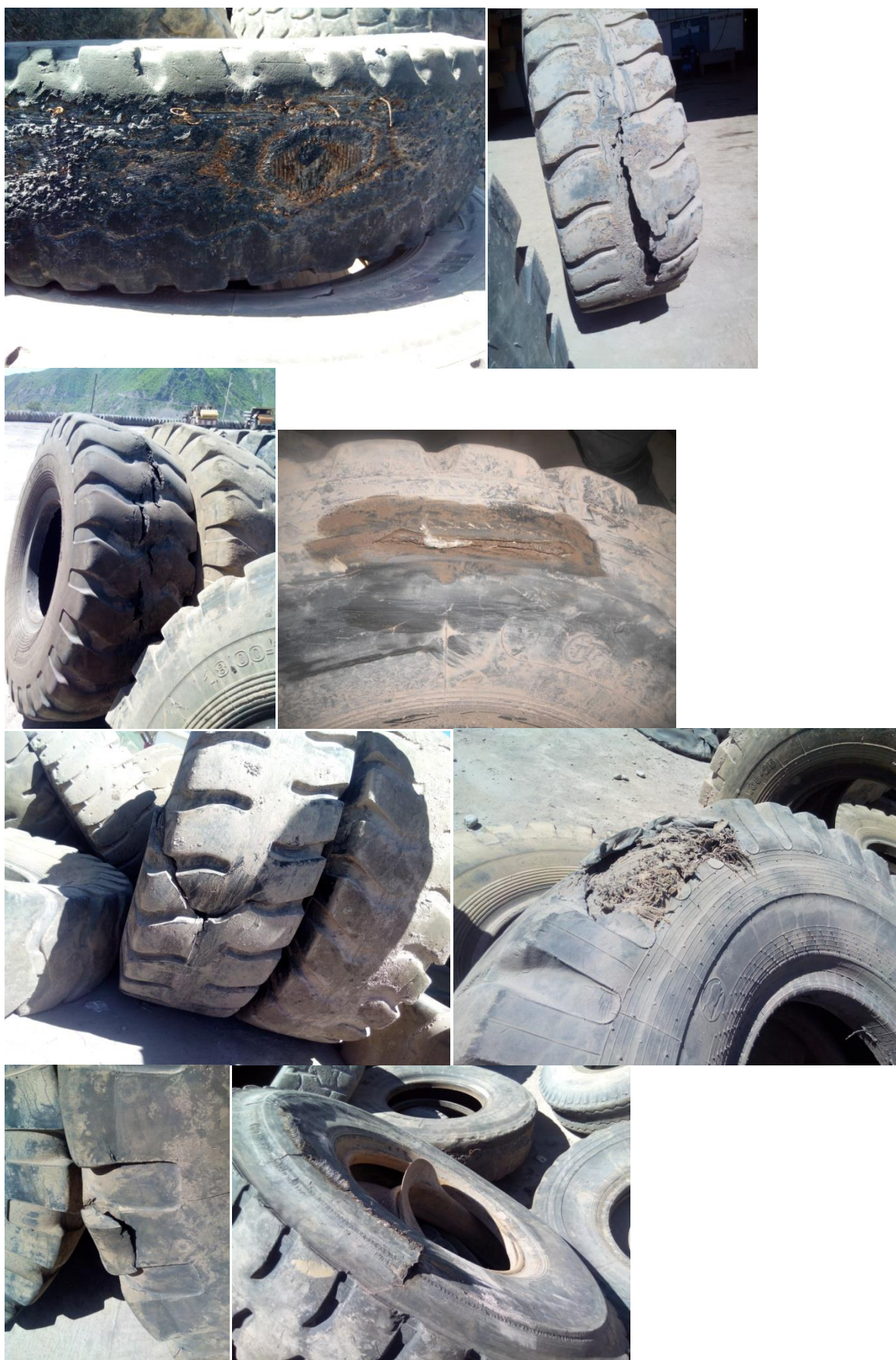
Рис. 4. Отказы шин, свойственные при эксплуатации автомобилей в горных условиях.
