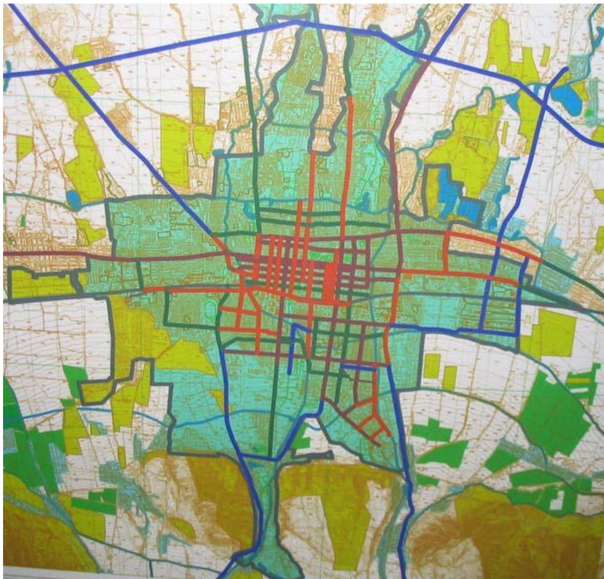
Рисунок 2 - Карта шума от транспортных потоков на территории г. Бишкек 2007 года: синими линиями – зона акустического дискомфорта (50-60 дБА), зелеными линиями - зона предельно-допустимого уровня (60-65 дБА), красными линиями – зона превышения I от предельно-допустимого уровня (65-70 дБА), коричневыми линиями - зона превышения II от предельно-допустимого уровня (70-75 дБА)
