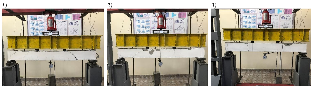
Рисунок 4. Физическая модель железобетонной балки
