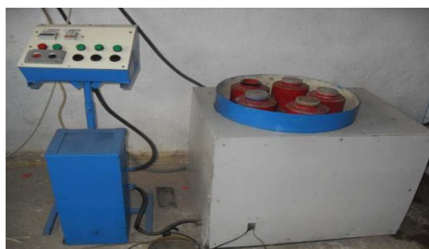
Рис. 3. Станок для планетарно-центробежной обработки самоцветных камней.
