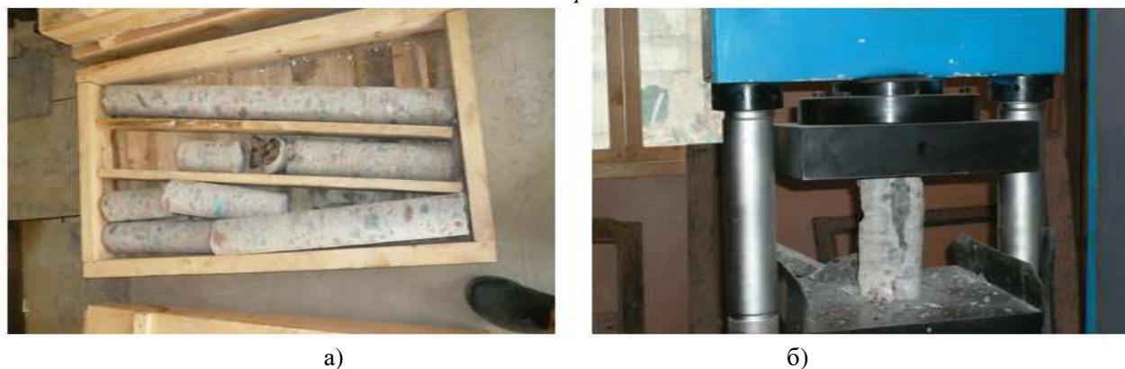
Рис.2. Фотографии отбора проб из бетонного покрытия: а) бурения бетонных кернов; б) измерения длины керна.
