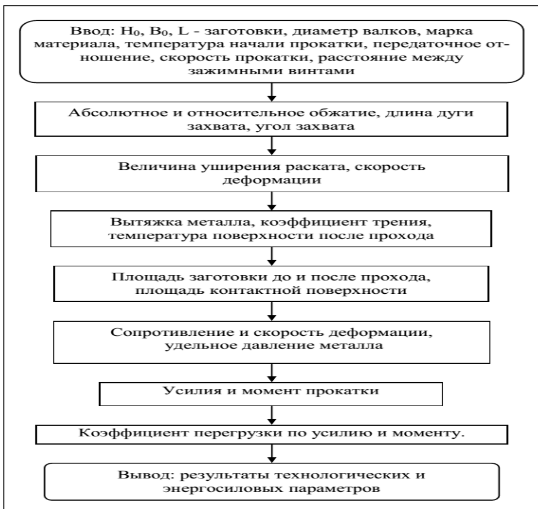
Рис. 3. Структурная схема алгоритма расчета энергосиловых параметров.
