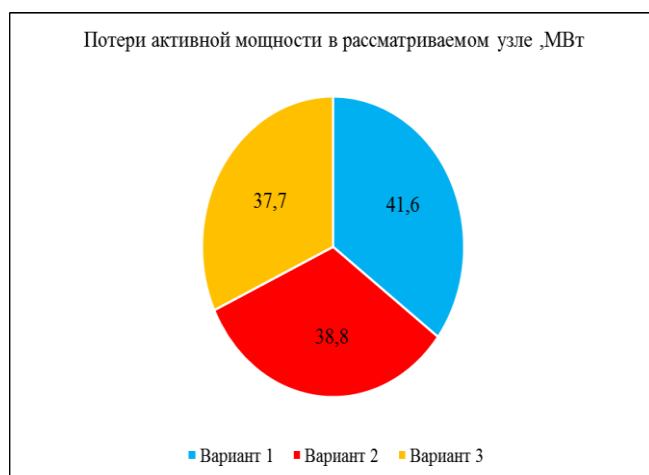
Рис. 3. Результаты расчёта потерь активной мощности в рассматриваемом узле, МВт.
