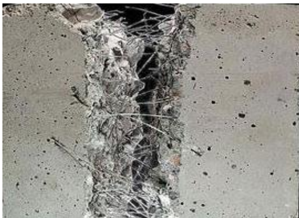
Рис 3. Бетон с увеличенными волокнами в составе бетона.
