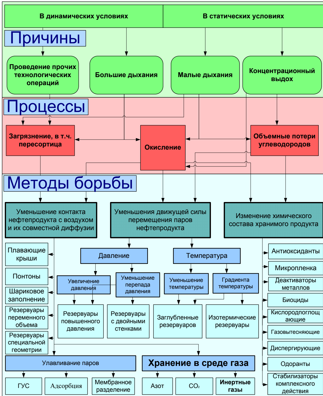
Рис.2 Структурная схема причинно-следственных изменений свойств и количества нефтепродуктов в резервуарах
