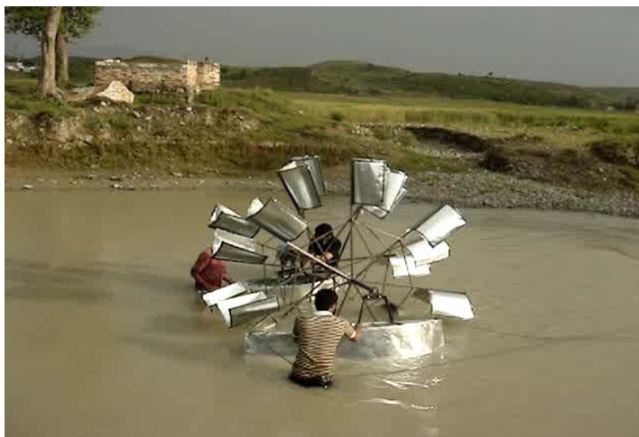
Рис.2.МГЭС с аккумуляторными батареями, установленная на катамаране.
