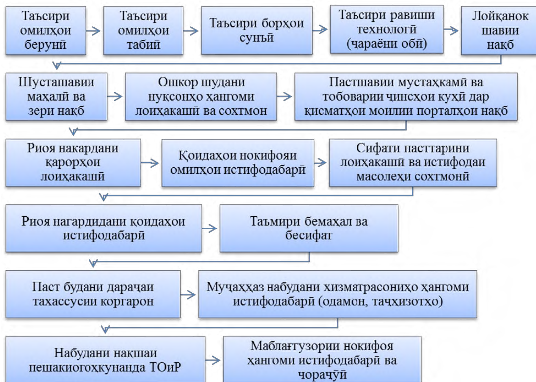
Расми 7 - Омилҳои асосии ба вайроншавӣ оварда расонидани нақбҳои гидротехникӣ ва иншооти обёрӣ.
