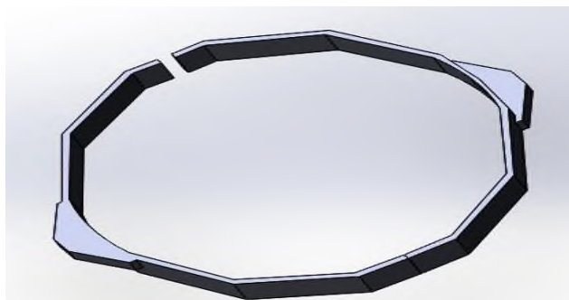
Рис.6. Конструкция расширительного кольца
