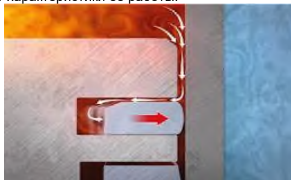
Рис.2. Действия газов на кольца при сжатии и рабочем такте
