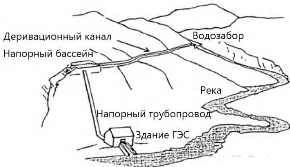
Рисунок 1–Принципиальная схема микро-ГЭС.
