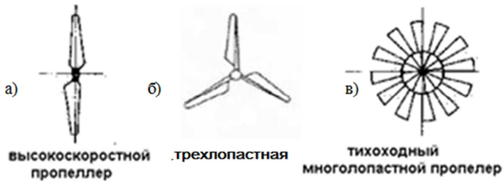
Рисунок 9. Основные ветроэнергетические установки
