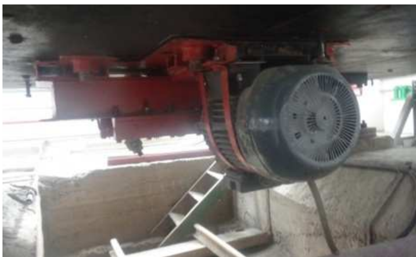
Рисунок 6. Крепление двигателя к нижней части виброплатформы
