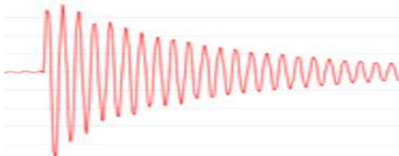
Рисунок 2. Собственные затухающие колебания виброплатформы при ударном воздействии
