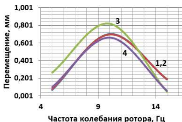
Рисунок 7. Графики перемещения различных точек модели с сейсмоизоляцией в зависимости от частоты вращения ротора при массе эксцентриксов m_1 = m_2 = 1,2 \text{ кг} : а- вдоль платформы; б- поперек платформы: 1 – поверхность платформы; 2 – опорная часть модели; 3 – плита перекрытия 1-го этажа; 4 – плита перекрытия 3-го этажа.
